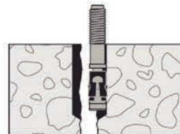
Falla por división del concreto
